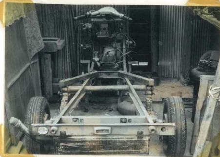
試作品No.6、No.7をオート三輪(日野オリオン、ハンビー)のプロペラシャフトを切断してその中間に設置し、拙宅の庭で試運転した。修理をくりかえして約1年間テストする。
