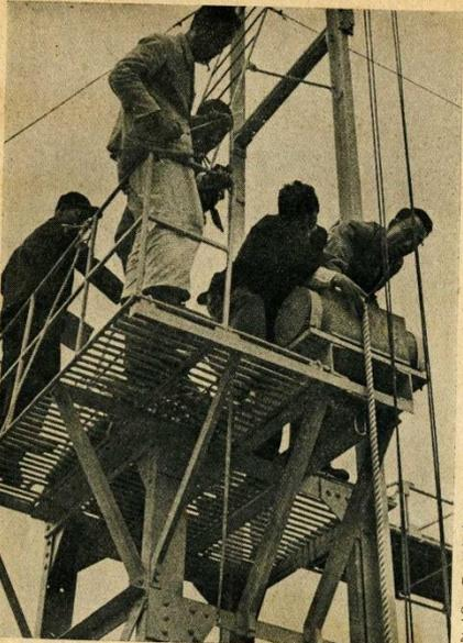
24 m/m マニラザイル破断試験機損傷調査 (昭和30年4月29日)
