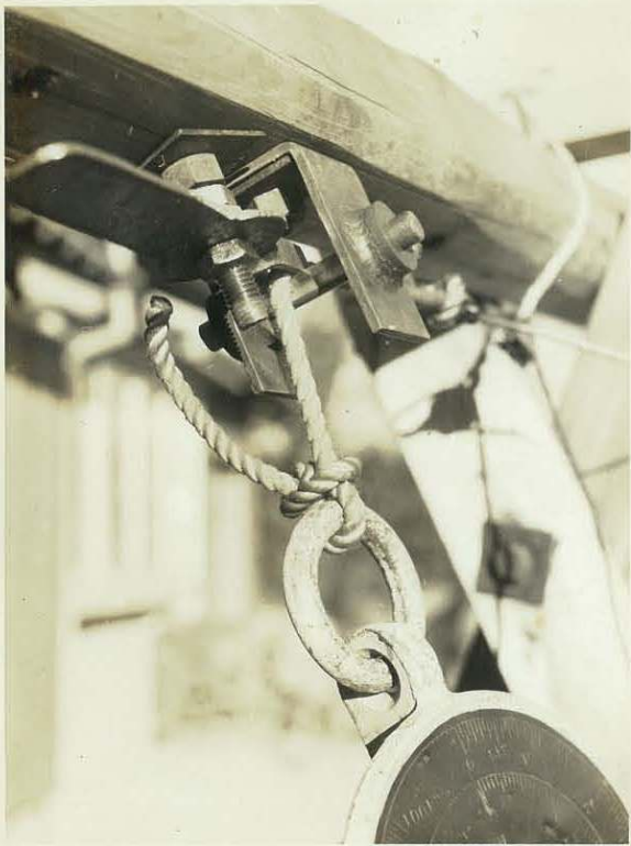
ヤガラ 上部につけられたエッジ 同じくエッジ上を往復運動 させている 状況
