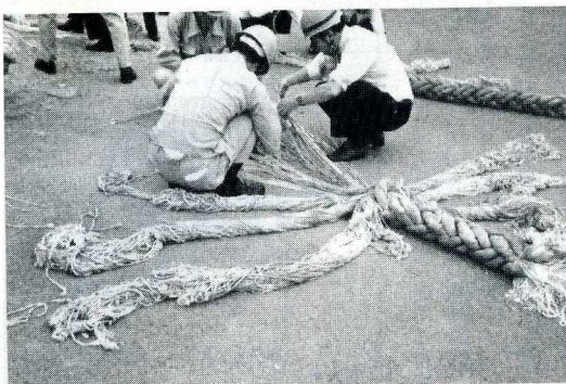
写真4. 直径120mmのナイロンロープの切断原因の調査風景
