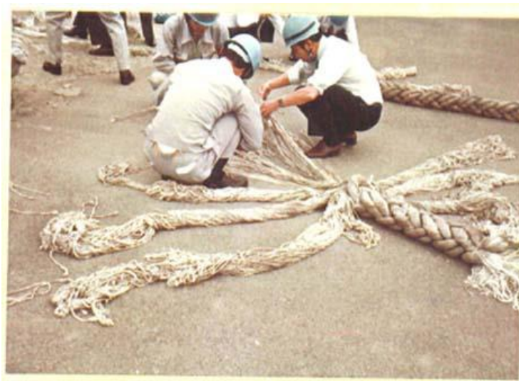
写真 3. 直径 120mm のナイロンロープの切断原因の調査風景
