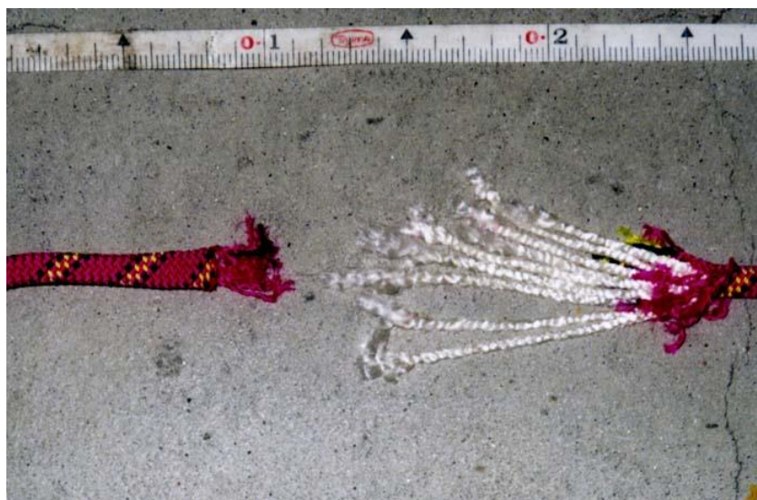
写真4. 現在の編みロープの衝撃せん断試験の結果。端がばらばらの方が墜落者側。
